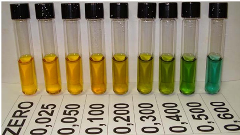
Figura 1. Tubos contendo concentrações crescentes de carbono em \text{mg mL}^{-1} em solução de biftalato de potássio após a digestão, utilizadas para a construção da curva padrão em cada comprimento de onda.
