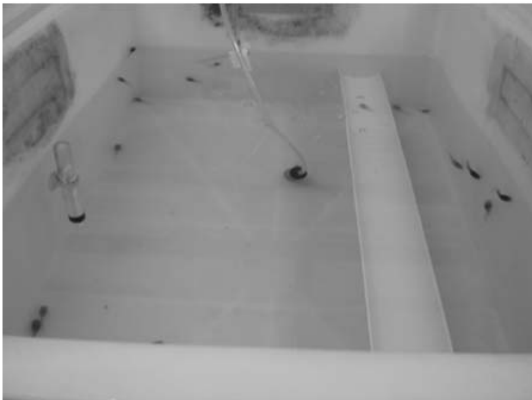
Figura 1. Posicionamento do cocho de pvc para alimentação no módulo experimental para girinos de rã-touro ( Lithobates catesbeianus )
