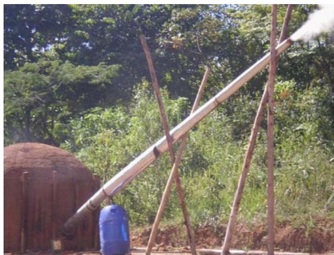
Figura 1. Tubo coletor acoplado ao forno na parte inferior em processo de coleta dos gases condensáveis
