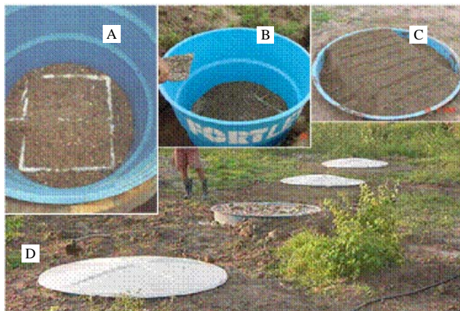
Figura 1. Detalhe da camada de cascalho e da tubulação de drenagem (A); preenchimento e reconstituição das camadas de solo (B); solo preparado para o plantio no interior do lisímetro (C); saturação e disposição dos lisímetros na área de plantio (D)
