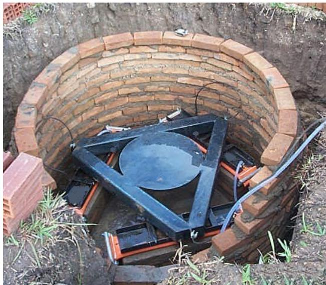
**Figura 4.** Detalhe do sistema de pesagem hidráulica: perfis metálicos e estrado metálico em forma de triângulo equilátero para recebimento do tanque de solo e grama
