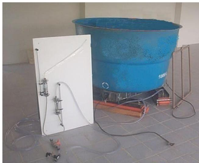
Figura 1. Componentes do lisímetro de pesagem hidráulica em fase de teste no laboratório
