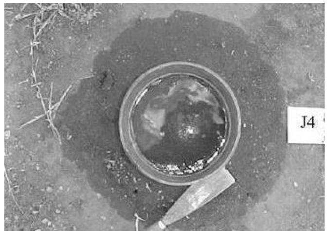
Figura 1. Teste de infiltração tridimensional com infiltrômetro de anel
