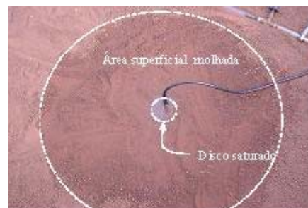
Figura 2. Modelo ilustrativo do disco saturado e da área superficial molhada
