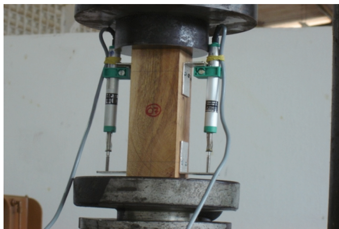
Figura 1. Corpo de prova e LVDTs posicionados entre os pratos da máquina de ensaio
